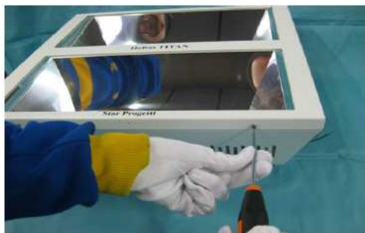
1. DEVISSER LES VIS QUI FIXENT L'ENCADREMENT
