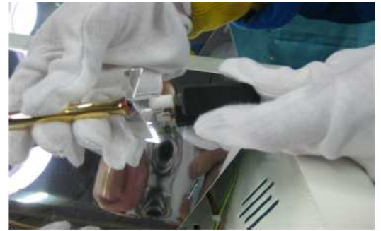
6. DIE FLACHSTECKER AN DER NEUEN LAMPE ANSCHLIESSEN UND DIE SILIKONDICHTUNGEN ÜBERSTREIFEN.
