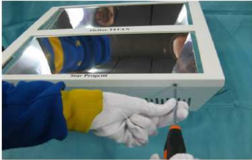
1. DIE ZWEI BEFESTIGUNGSSCHRAUBEN DES RAHMENS LÖSEN.
