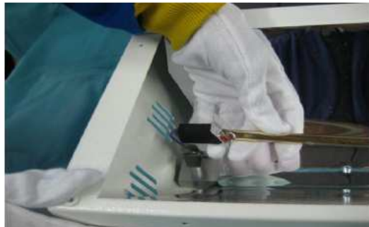
3. DIE SILIKONDICHTUNGEN AN DEN BEIDEN ENDEN DER LAMPE AUS DEN FEDERN LÖSEN.
