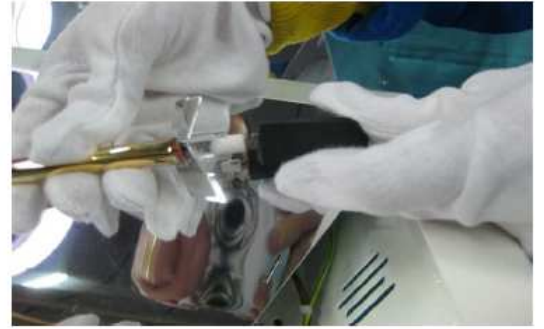
6. VOLVER A CONECTAR LOS FASTON EN LA NUEVA BOMBILLA Y REVESTIRLA CON LAS GUARNICIONES DE SILICONA.
