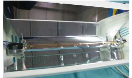
7. VOLVER A COLOCAR LAS GUARNICIONES DE SILICONA EN LA SEDE DE LOS DOS RESORTES, COMO SE ENCONTRABA ORIGINALMENTE.
